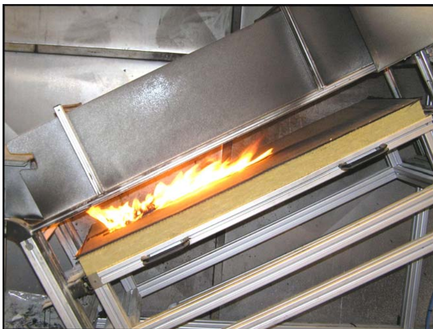
Figur 2. Exempel på provning av en taktäckning som ger en fortgående brandspridning och därmed inte motsvarar nordiska krav.
